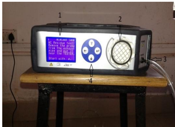
Fig. 6. AVL DIGAS 444N gas analyser
